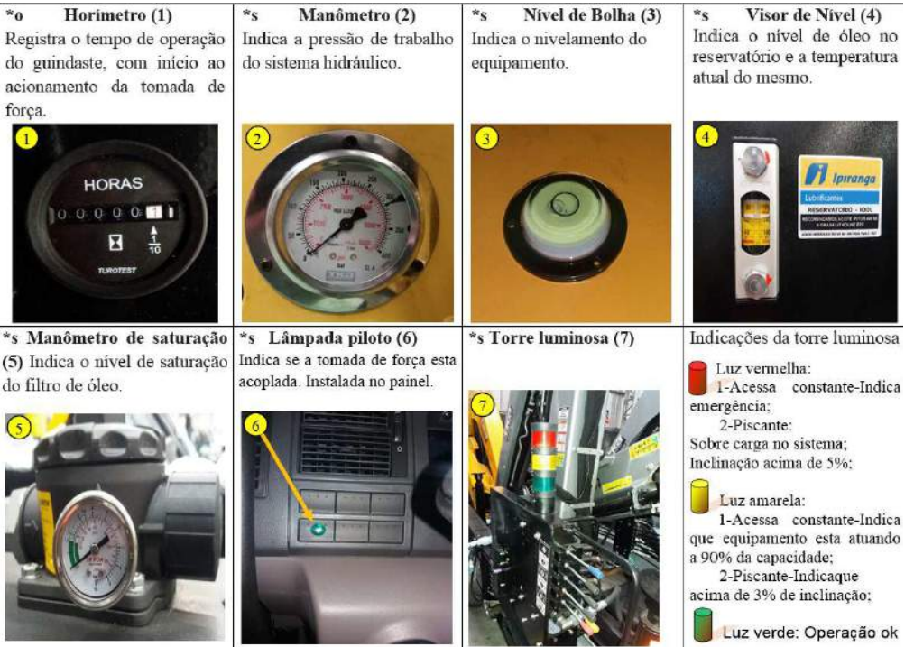
Figura 9 - Sistemas Indicadores do Equipamento
